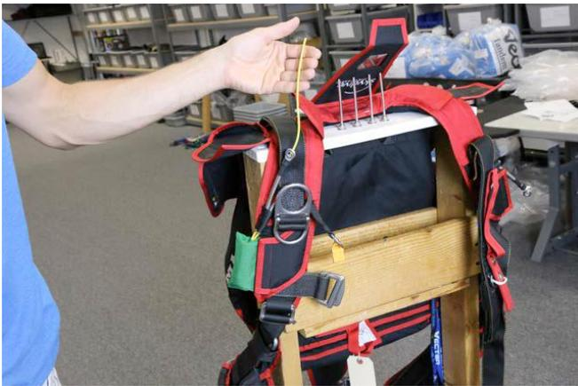
Passe os cabos do corte de suspensão pelas traqueias. O cabo esquerdo apenas pela primeira secção da traqueia.
