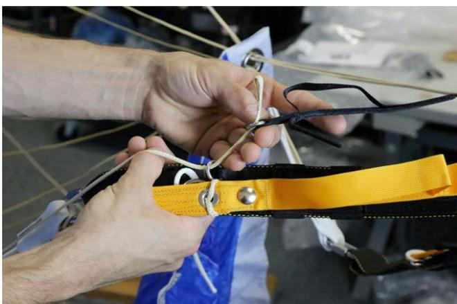
Passa o cordão do manobrador secundário pelo anel mais pequeno e depois pelo anel do punho do manobrador (manobrador negro).
