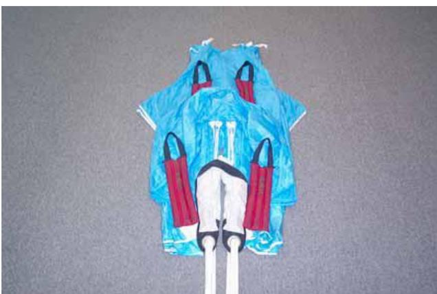
Inicie do outro lado da calote repetindo os passos para organizar desde o nariz da calote, A, B, C, D e cauda. Suba o slider e posicione-o ao centro, com o tecido dividido em 4 partes com as laterais posicionadas entre os grupos de cordões B e C e sem expor demasiado na frente e atrás. Certifique-se que o *canal de insuflação* no centro está livre, e que todos os cordões e os seus
