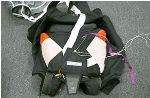
Dobre a tira paralelamente ao bordo lateral da pala #2a e coloque-a sob a pala.
