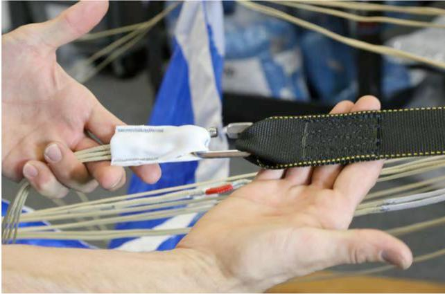
Passar o anel desmontável pela tira, com o cilindro de fecho para o lado da tira de suspensão (ver imagem). Assegurar-se da boa ordem dos cordões.
