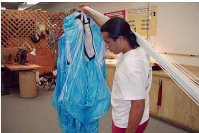
Abra o nariz da calote com metade das células à esquerda e à direita e a célula central totalmente exposta, no meio.
