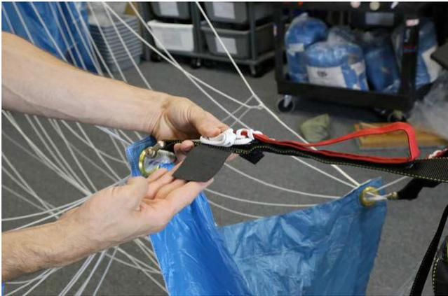
Acondicione o excesso de cordão junto ao anel guia da tira de suspensão.
