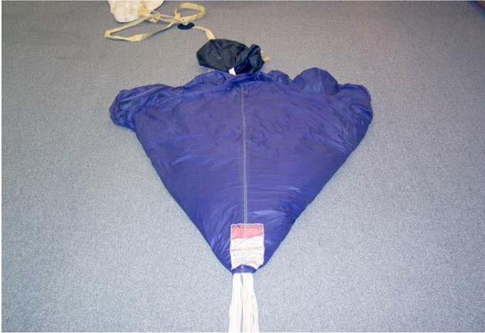
Coloque a calote com tensão para a frente de forma que, quando colocada no solo pareça mais comprida do que larga.
