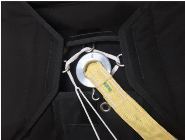
Use uma *ajuda* para fecho em cordão spectra de 750 ou 1000 lbs. Passe a ajuda pelos anéis em D e em volta do disco para fechar o contentor.
