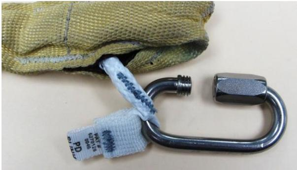
O anel desmontável será depois montado no Soft Link, tira do drogue e loop de fixação do saco interior.
