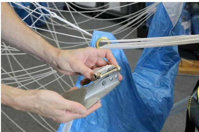
Remova os parafusos e abra o anel em "L" usando a ferramenta para o efeito.
