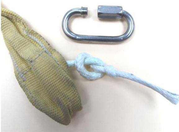
**Se notar que o Kill Line está demasiado longo, um simples nó realizado na extremidade do lado do saco interior e acima do nó do loop do Kill Line, reduzirá de forma eficaz cerca de 2" (51 mm) e ajustará o colapso do drogue ao trim ideal.**
