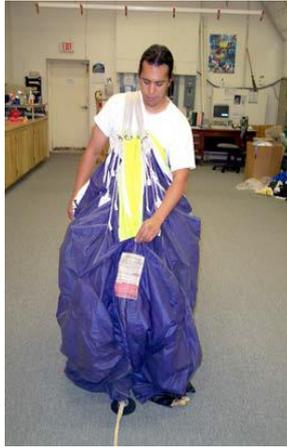
Separe os estabilizadores. Separe o tecido de cada um dos lados para o exterior mantendo os cordões e os seus pontos de ligação, ao centro. Abra o slider em 4. Separe a cauda e abra o tecido para o exterior entre cada um dos cordões do manobrador. Mantenha os cordões e os seus pontos de ligação ao centro.
