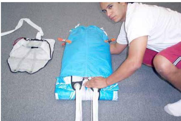
Pressione e mantenha a tensão nos cordões e os anéis do slider no seu sítio.
