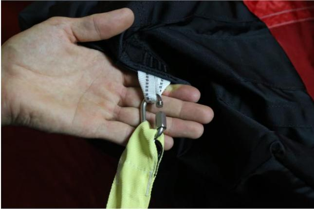
Conecte o drogue ao loop exterior do saco, usando um anel desmontável.
