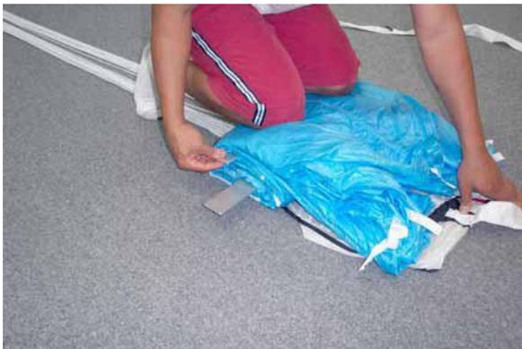
Use os joelhos para controlar a calote dobrada e retire as régua de dobragem.
