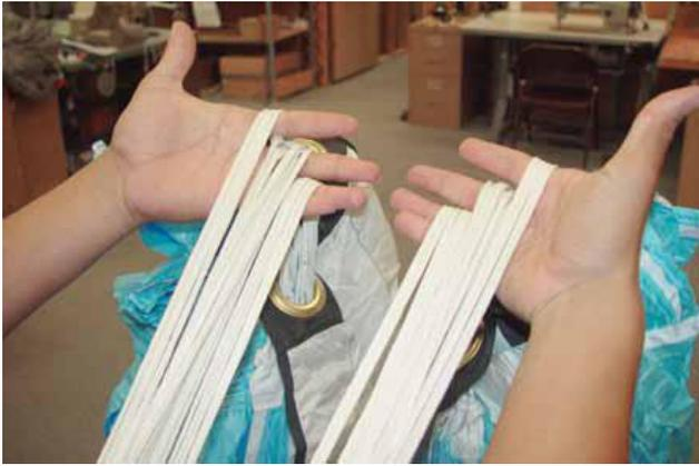
Antes de iniciar a dobragem inspecione a calote certificando-se que não existe nenhum estrago e que os cordões estão ordenados convenientemente. Confirme que os cordões dos manobradore se encontram atados nos anéis em “L”.
