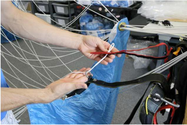
Passar o cordão do manobrador pelo anel guia na tira de suspensão e depois pelo ilhós do punho do manobrador.
