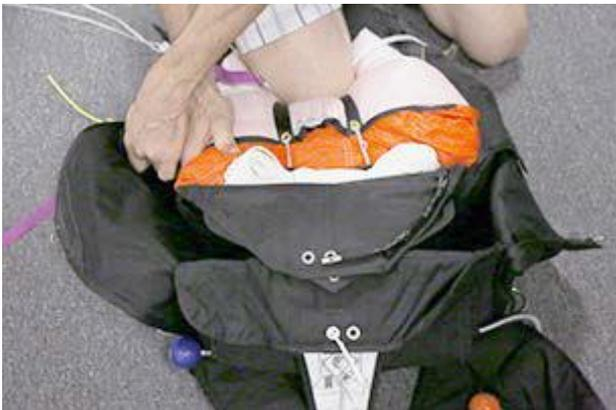
Posicione o DAA no recorte criado para o efeito, e encaixe os cantos do volume no contentor do reserva. Preencher completamente os cantos inferiores do contentor com a calote, movendo-a ligeiramente para um lado e para o outro.
