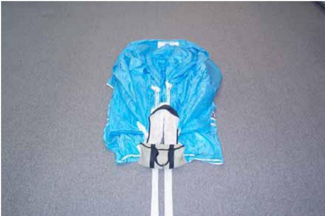
Coloque um saco de pesos para dobragem na base da calote, e mantenha a tensão nos cordões. *Passe* a calote do centro para o exterior, de cada lado, mantendo os cordões centrados.
