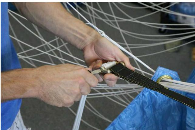
Coloque e aperte os parafusos completamente, sem usar de força excessiva. Certifique-se que o anel em “L” está bem encaixado, confirmando a sua posição durante o aperto dos parafusos. Repita o procedimento com os restantes anéis.
