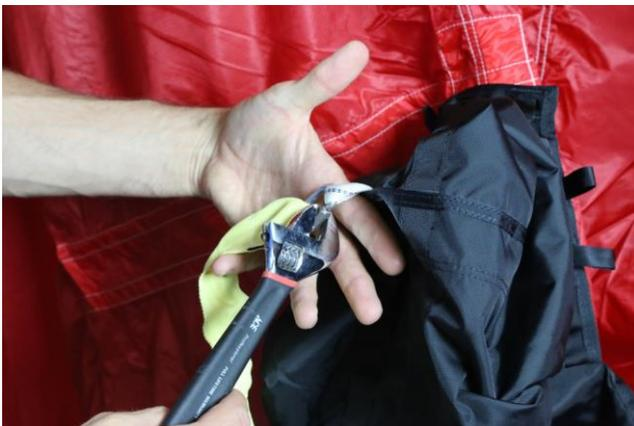
Use uma chave para apertar o anel desmontável, aproximadamente 1/8 de volta ou até estar convenientemente apertado. Cuidado! O aperto excessivo pode danificar o anel.
