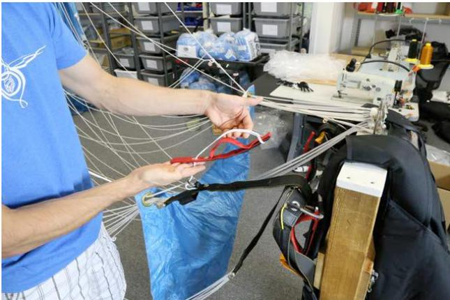
Passar o loop do cordão do manobrador pela base do punho do manobrador.
