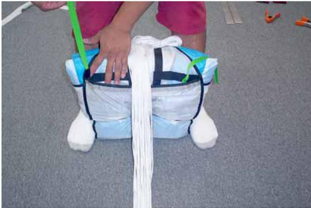
Coloque 2 protecções para Velcros na bolsa de acondicionamento dos cordões, ou uma única de um lado ao outro que mantenha os cordões no lugar e garanta a bolsa aberta.
