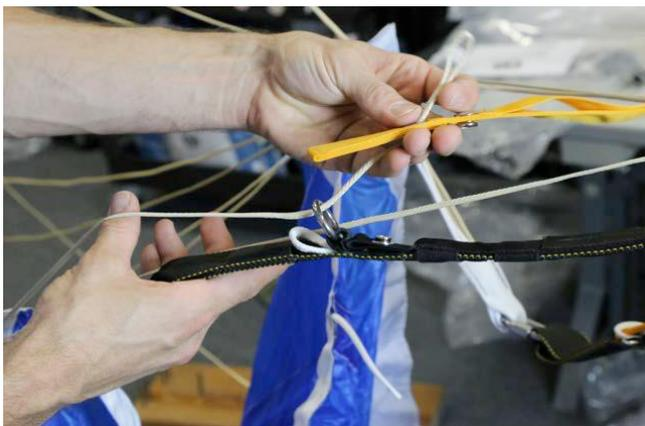
Passa o cordão do manobrador primário pelo anel mais largo e depois pelo ilhós do punho do manobrador.
