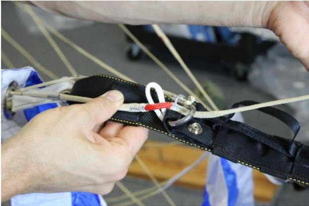
Passe o loop de dacron da tira de suspensão através a abertura existente no manobrador principal.
