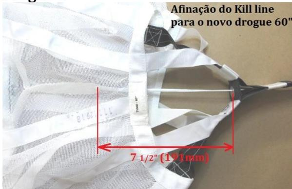
Usando a mesma técnica anteriormente mencionada, aplicando a tensão de cerca de 10 lbs da mesma forma, o nó "cabeça de cotovia" de ligação do Kill Line ao drogue deve estar a 7 ½" (191 mm) do ilhós guia do Kill Line nos novos drogues. (configuração de fábrica).
