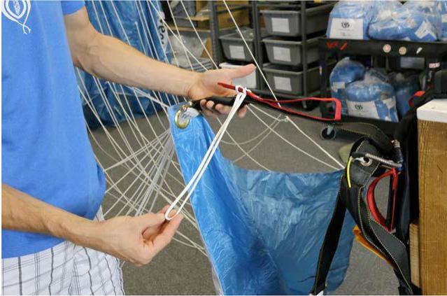
Coloque o punho do manobrador no velcro da tira de suspensão e aperte a mola.
