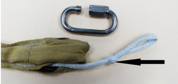
O colapso do drogue está calibrado para uma razão de descida e peso médios. Se notar que o drogue está a colapsar-se demasiado e com um “trap door effect” mais longo que o normal, pode alongar o Kill Line desatando o nó e reajustando o tamanho. O “trap door effect” ideal demora cerca de  $\frac{3}{4}$  de segundo, no mínimo  $\frac{1}{2}$  segundo.
