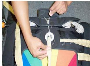
Passe o loop do principal através da chaminé do disco e segure-o com o pino do principal, tal como se mostra na imagem. Esta acção permitirá imobilizar o disco para colapsar o drogue.
