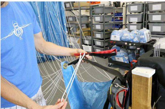
Insira o topo do punho do manobrador no loop de Dacron, com o excedente de cordão afastado do contentor.
