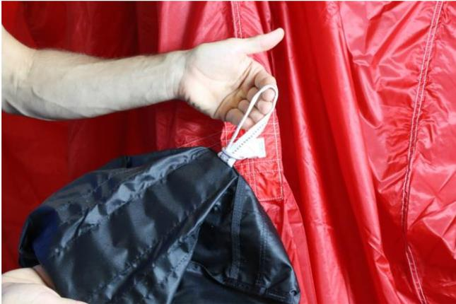
Passa o loop que está no interior do saco pelo ponto de fixação da calote.
