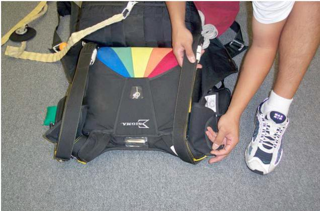
Acondicione as tiras de suspensão ao longo dos lados do contentor do reserva. Certifique-se de que as tiras de suspensão não ficam sobre as palas dos ombros.
