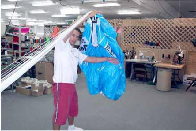
Segure os cordões numa das mãos com alguma tensão para a frente, uso o braço que tiver livre para dar suporte ao tecido da calote enquanto a coloca suavemente na superfície de dobragem.
