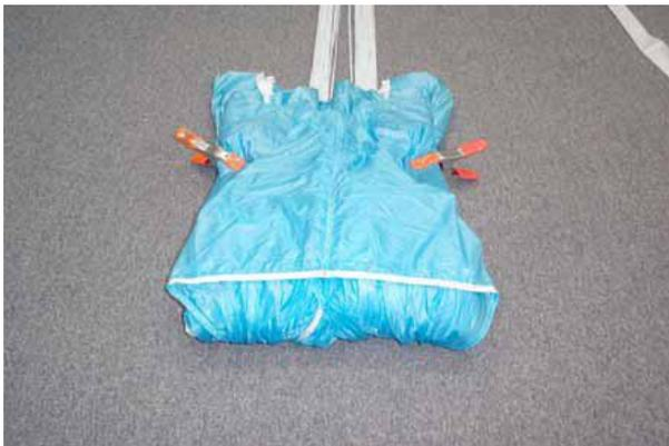
Certifique-se que as células do nariz se encontram dobradas e posicionadas junto ao centro. Colocar a célula central a cobrir toda a largura do *charuto*, incluindo as células dobradas de ambos os lados.
