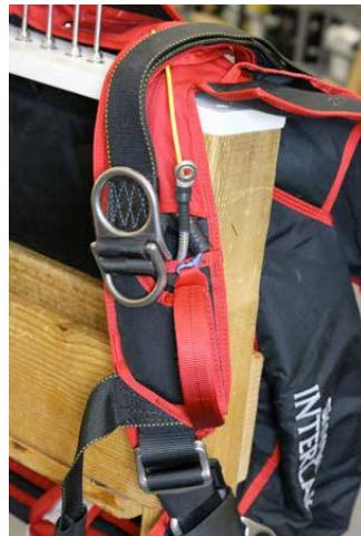
Passe o cabo do punho do reserva através da traqueia. Coloque o punho no seu alojamento, fixo no velcro.
