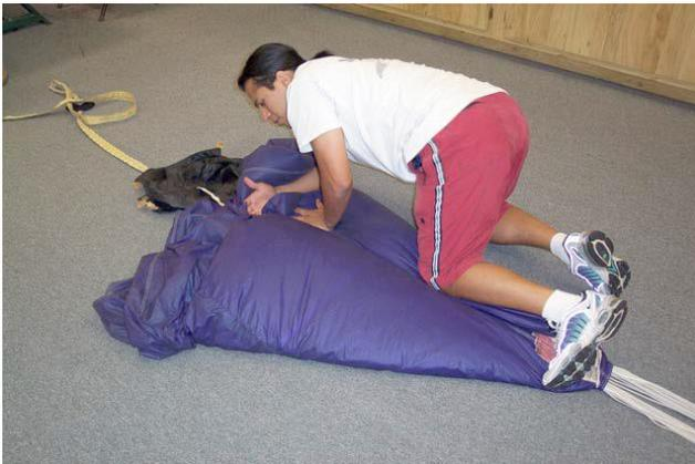
Retire o ar à calote, tendo atenção para que nenhum cordão se mova do centro. Faça os movimentos sempre direccionados para o topo da calote para manter a tensão nos cordões.
