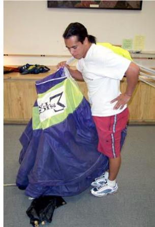
Coloque os cordões sobre os ombros e passe o nariz da calote, célula por célula. Quando tiver passado todo o nariz, coloque as células (nariz) entre os joelhos e segure-as aí.
