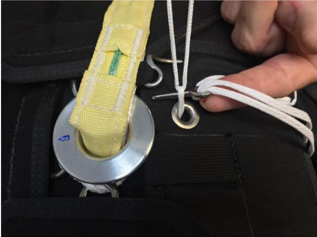
À medida que as 4 palas se juntam, certifique-se que o disco permanece centrado, com a seta a apontar para o contentor do reserva. Introduza o pino no loop confirmando que os anéis em D e o loop de fecho estão sob a falange do disco.
