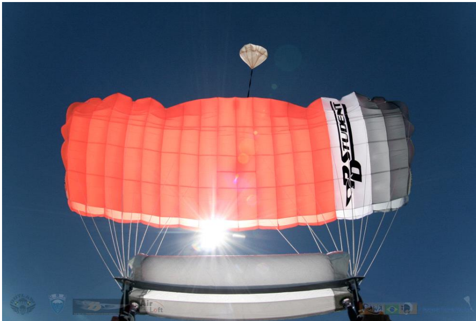
Fig. 19 - Velame Aberto – Tem sustentação, está voando reto, formato retangular, células infladas, linhas esticadas e desembaraçadas, slider baixo
